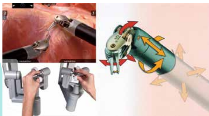
図2 写真左下の術者の手の動きを写真左上のロボットアームが再現します。ロボットアームは多くの関節があり人の手よりも自由自在に動きます。
